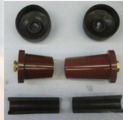
Bild 12: Demontage der Prüflinge Prüfstrecke 2, 19H19 nach Abschluss der Prüfungen beansprucht mit DAC +/-, ca. 450Hz
