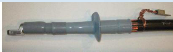
Bild 9: Prüfling CAESK-I 24kV Gr.3 auf 12/20kV NA2XS2Y 240mm²
