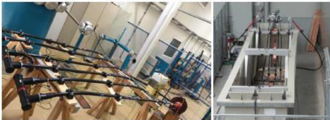
Bild 6: Versuchsaufbau Lastwechselprüfung 240mm 2 (links, Labor CPT) und 95mm 2 (rechts, Labor CPR)
