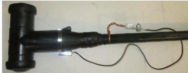
Bild 10: Prüfling CTS 630A 24kV, 95-240mm² auf 12/20kV NA2XS2Y 240mm²
