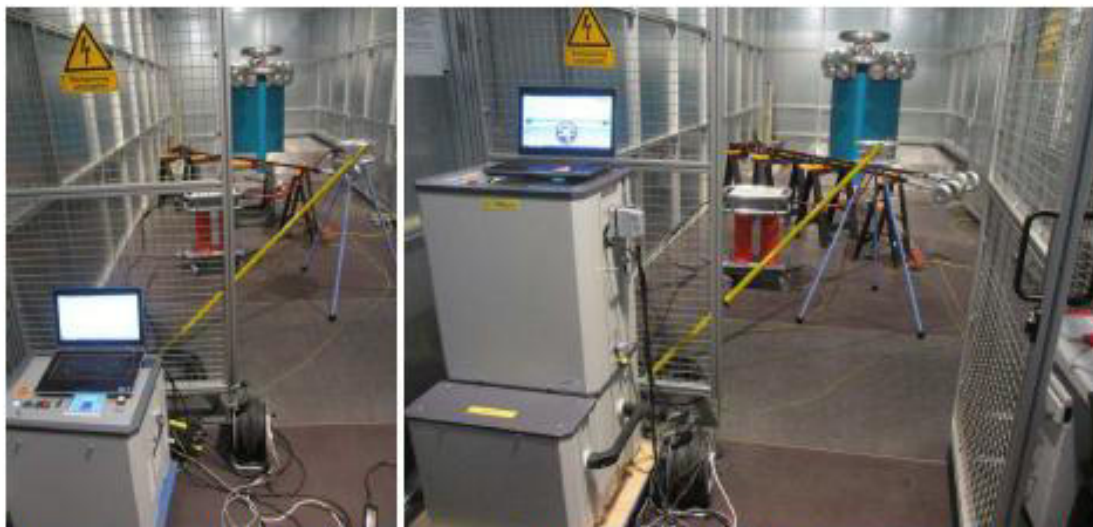
Bild 5: Versuchsaufbau VLF Sin 0,1 Hz (links) und VLF CR 0,1 Hz bzw. DAC (rechts)
