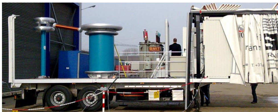
System mobilny do prób napięcia doprowadzonego dla transformatorów mocy
