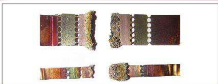
Rys. 3. Topik wkładki po zadziałaniu w przypadku przepływu prądu przeciążeniowego: u góry – 80 A, u dołu – 40 A. W miejscu przepalenia się topika widoczne są duże ilości przyklejonego, nadtopionego piasku kwarcowego
